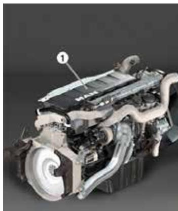
Fig. 1: Testata unica nel MAN D2066 CR (Pos. 1)
